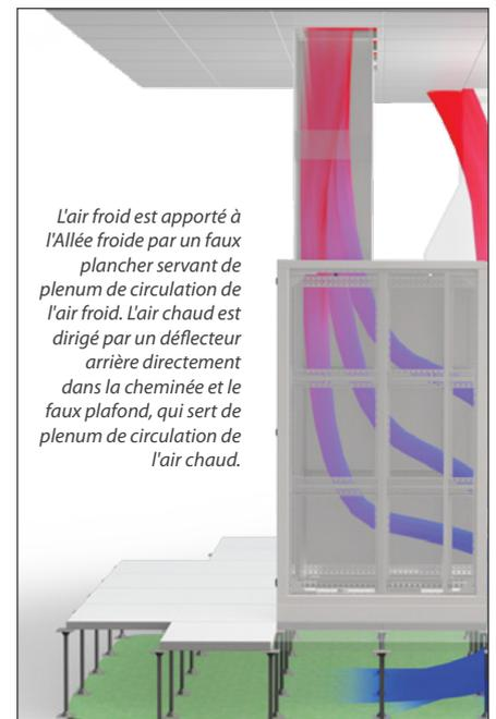
L'air froid est apporté à l'Allée froide par un faux plancher servant de plenum de circulation de l'air froid. L'air chaud est dirigé par un déflecteur arrière directement dans la cheminée et le faux plafond, qui sert de plenum de circulation de l'air chaud.
