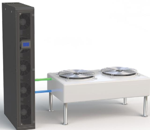
L'unité CoolTeg XC comporte un compresseur intégré et chaque unité intérieure est raccordée par une canalisation réfrigérante en cuivre au condenseur extérieur. Elle est dotée de compresseurs EC modernes et de vannes de détente électroniques, de même que de ventilateurs EC en standard.
