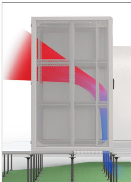
*L'air froid est dirigé vers la zone froide par un déflecteur. Une zone froide est créée par un cadre de séparation d'air, des obturateurs et une porte avant pleine. L'air chaud est évacué de la baie au travers d'une porte super-ventilée.*
