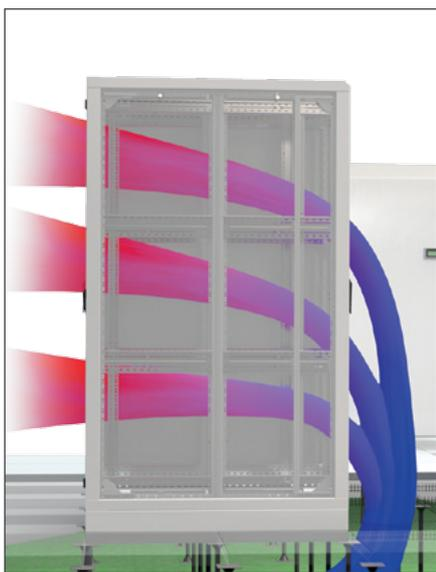
*L'air froid est apporté à l'Allée froide par un faux plancher servant de plenum de circulation de l'air froid. L'air chaud est expulsé par l'arrière de l'Allée chaude.*
